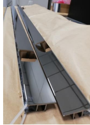
Campione 2 – nessuna presenza di corrosione su entrambi i profili
