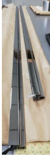
Campione 1 – nessuna presenza di corrosione su entrambi i profili
